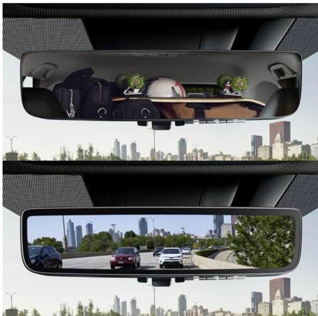
Le nouveau rétroviseur numérique offre au conducteur une meilleure vue d'ensemble de son environnement. Il vous suffit d'appuyer sur un bouton pour que le rétroviseur intérieur à atténuation automatique se transforme en rétroviseur numérique haute définition. Et puisqu'il utilise une caméra fixée en hauteur sur le pare-brise arrière du RAV4, l'écran vous garantit une vue dégagée, même lorsque des objets placés dans le coffre masquent votre visibilité.
